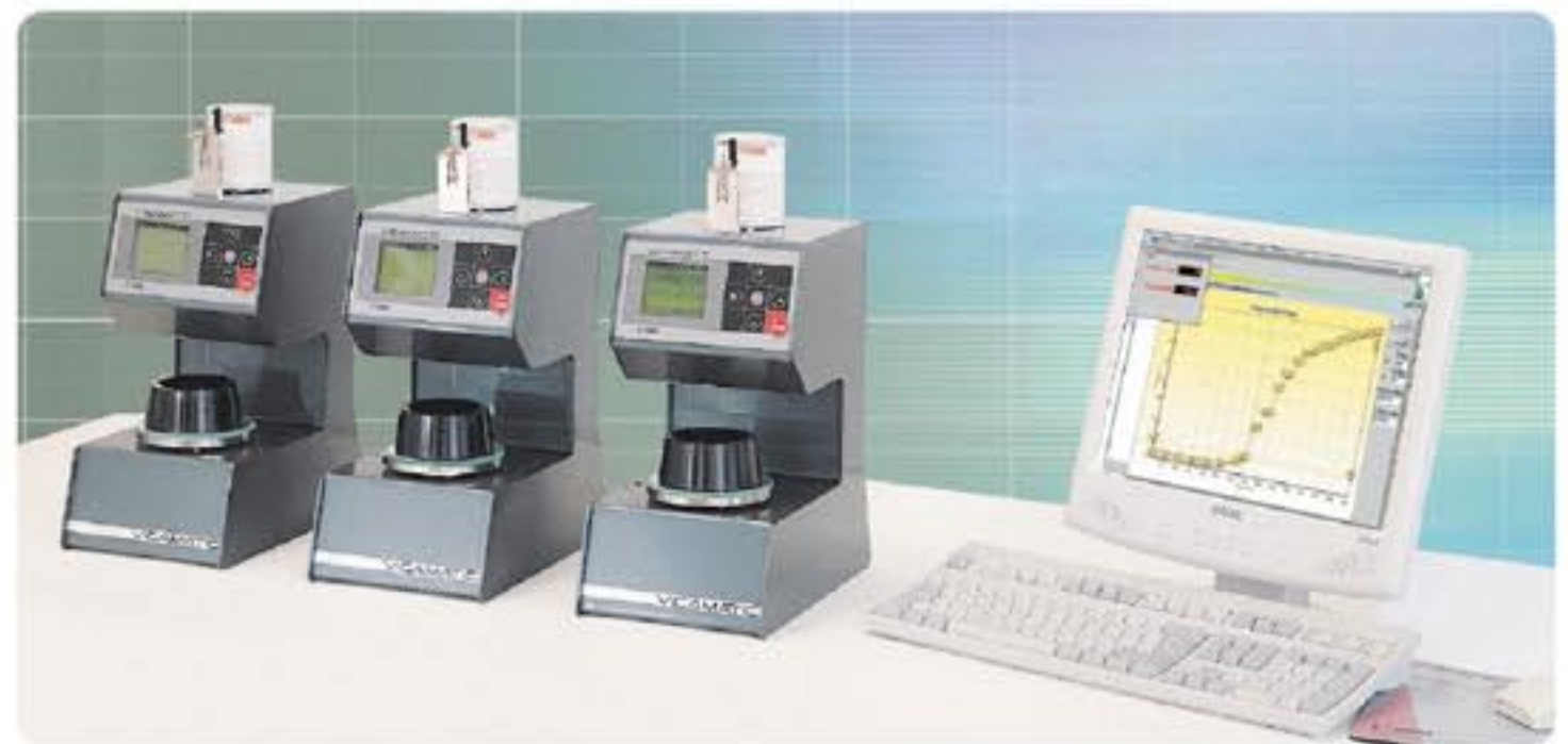
Sistemas de ensayos múltiples Vicat (ampliables hasta 16 unidades) conectados a un PC
