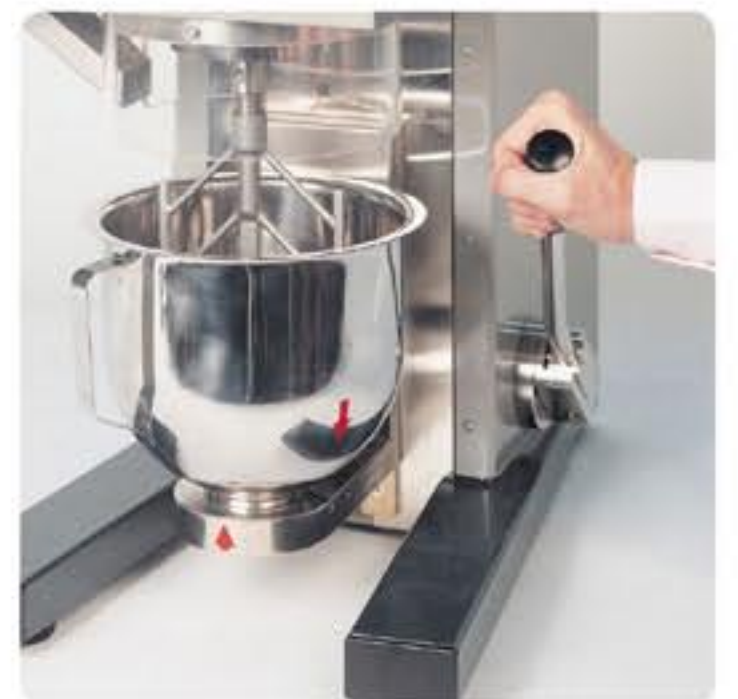
Detalle de desplazamiento vertical de la cubeta
