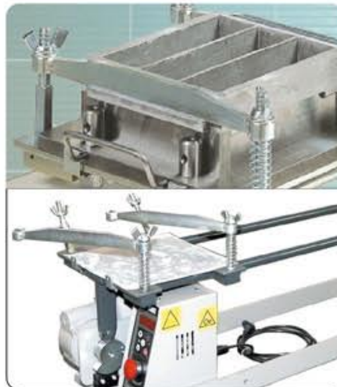
Detalle del sistema de bloqueo rápido del molde
