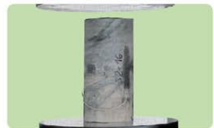
Detalle de muestra de roca con galgas extensiométricas acopladas
