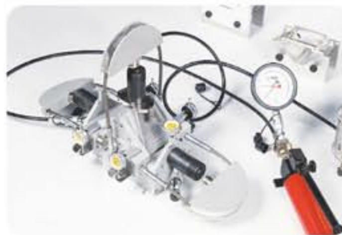
Detalle del aparato de caja de corte con el accesorio 45-D0548/10 para la ejecución del ensayo de conformidad con la norma ASTM D5607.
