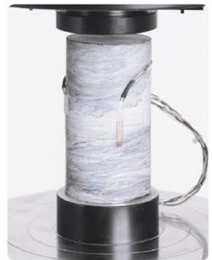
Ensayo uniaxial: detalle de muestra de roca con galgas extensométricas acopladas 82-P0392
