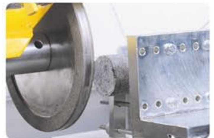
Detalle de 45-D0536 con disco de esmerilado diamantado de dos caras durante una operación de pulido de extremos de muestras cilíndricas
