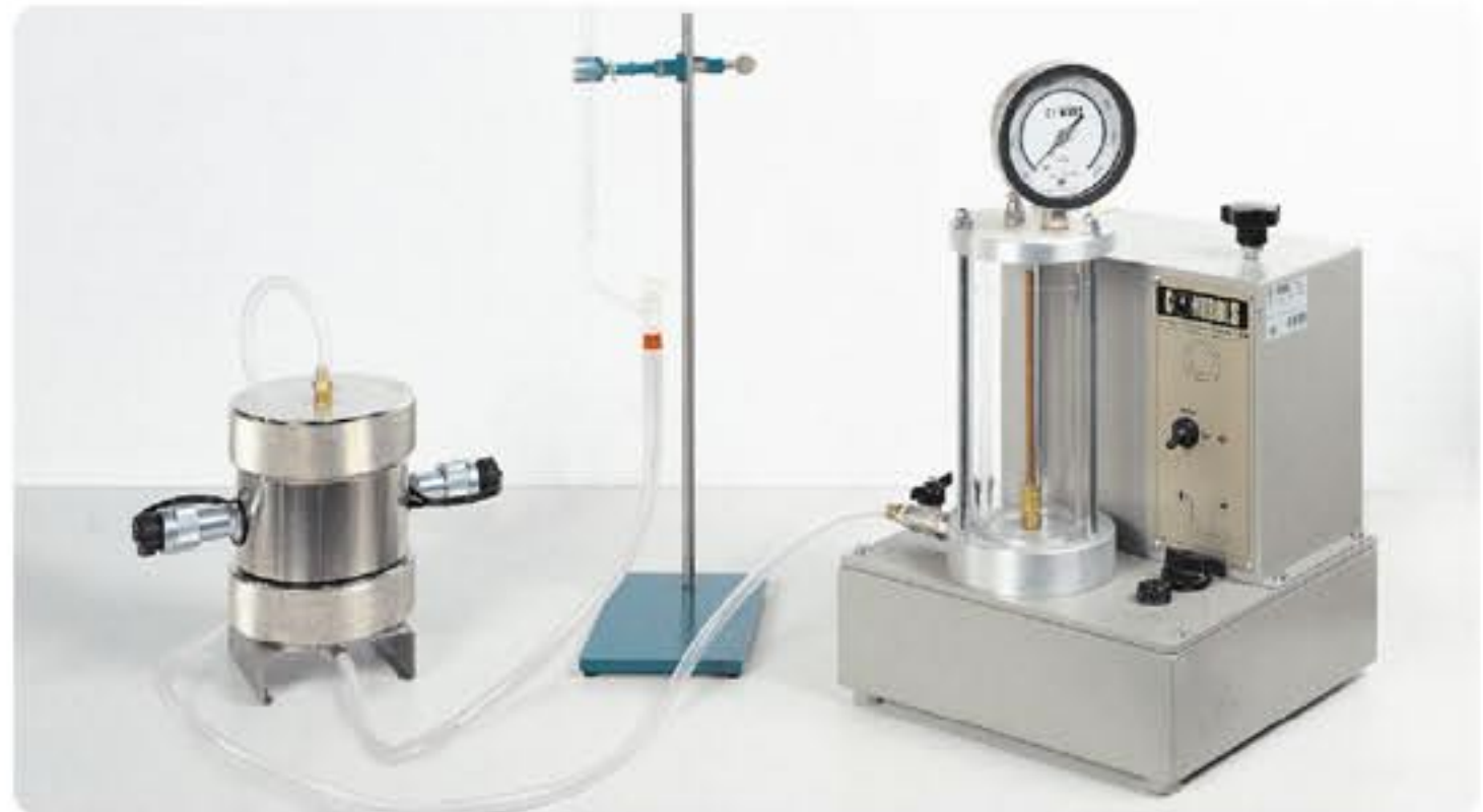
28-WF4312 con célula de Hoek, tapas de permeabilidad, bureta, base y manguito de metal y vidrio
