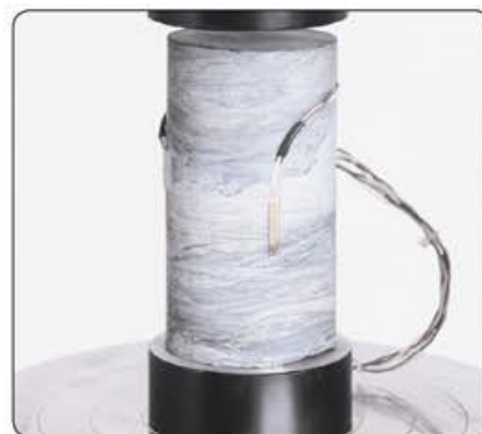
Detalle de muestra de roca con galgas extensométricas acopladas 82-P0392
