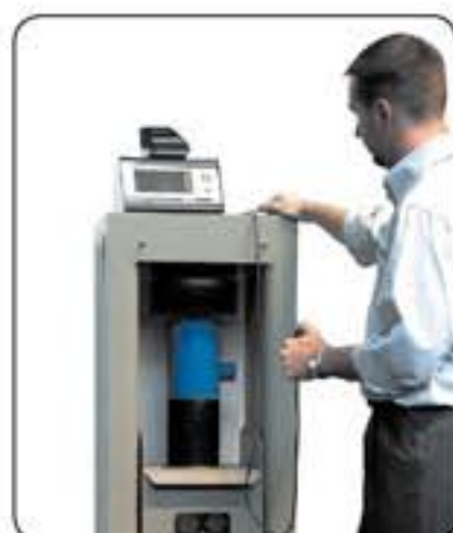
Comprobador digital 82-P0801/E con impresora 82-P0172 y célula de carga durante el proceso de calibración
