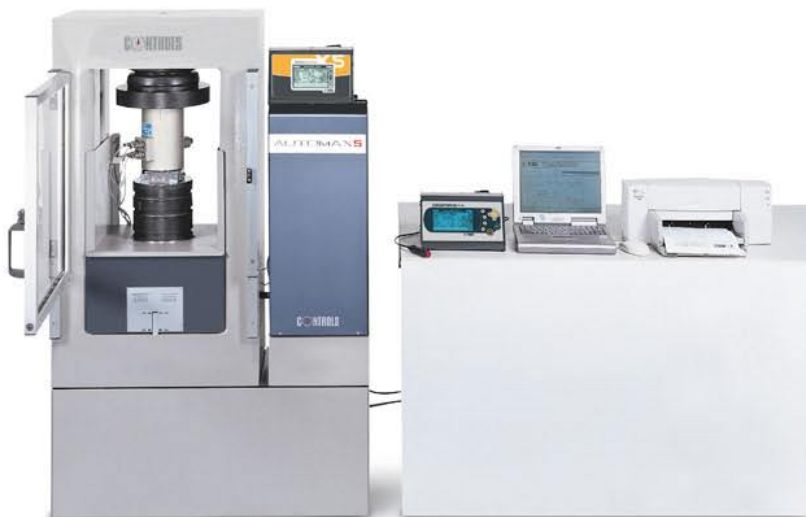
Verificación de la transferencia de fuerza de una máquina de ensayos de compresión mediante la columna con medidor de deformación 82-E0105/1, comprobador digital 82-P0804/E, PC, impresora y software 82-P0804/E1
