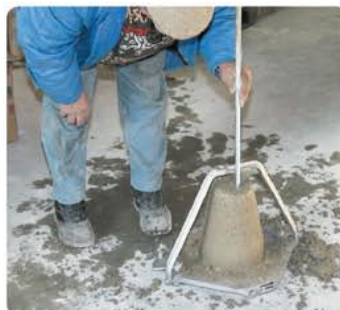
54-C0149/B durante el funcionamiento. El asa sobresale por encima de la muestra y el asentamiento se mide mediante la varilla apisonadora graduada en pasos de 1 cm.
