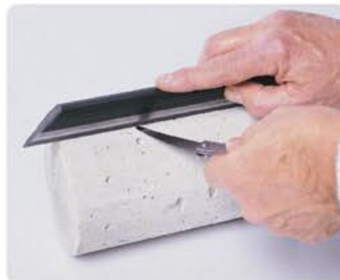
Verificación de la rectitud de la generatriz de los cilindros mediante reglón y galgas de espesores
