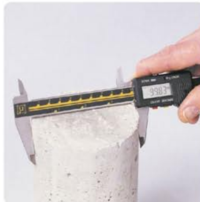
Verificación de diámetros mediante calibre de nonio digital
