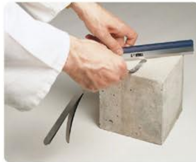
Verificación de la rectitud mediante reglón y galgas de espesores
