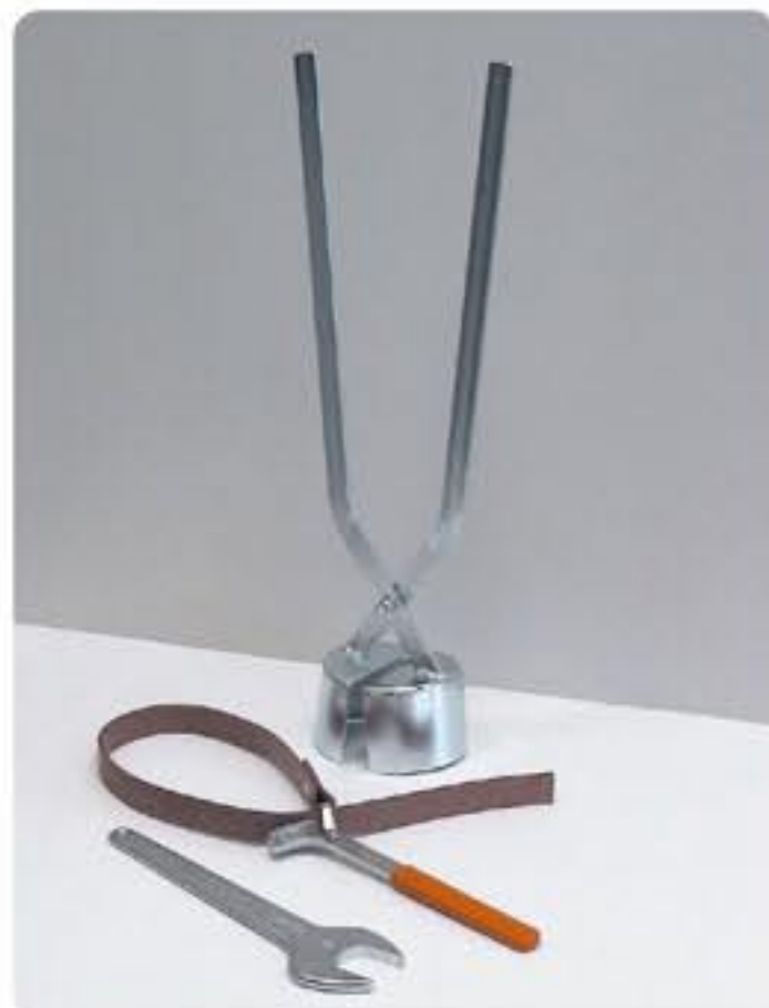
Llave de correa suministrada con la máquina y extractor de testigos 83-C0312/2
