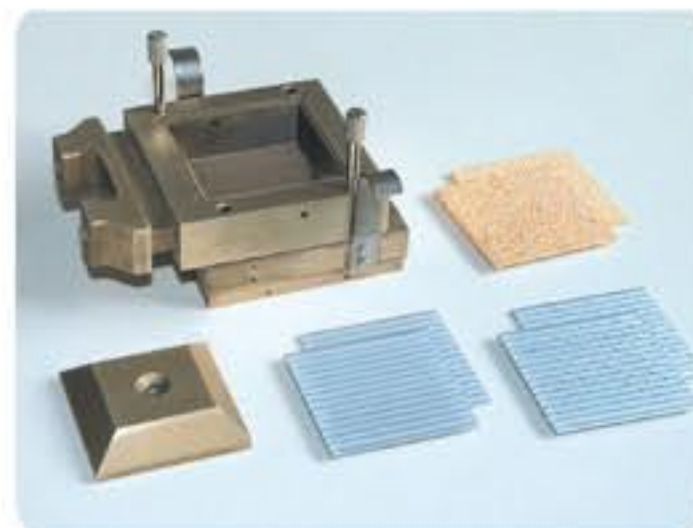
Componentes de una caja de corte cuadrada
