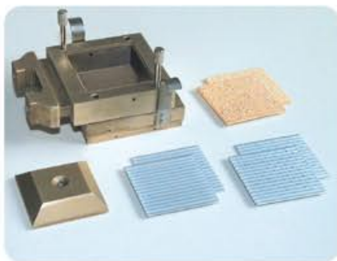
Componentes de las cajas de corte cuadradas
