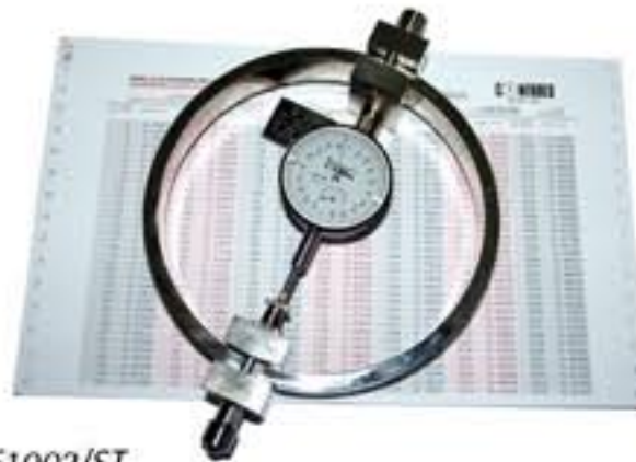
27-WF1002/ST Anillo dinamométrico con adaptador
