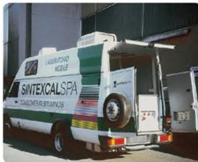
Laboratorio de asfalto, montado en furgoneta, suministrado a SINTEXCAL, Italia. Con generador eléctrico y equipo de aire acondicionado.
