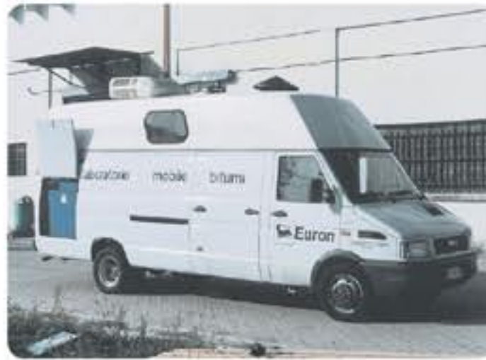
Laboratorio de betón, montado en furgoneta, suministrado a EURON, Italia. Con generador eléctrico y equipo de aire acondicionado.
