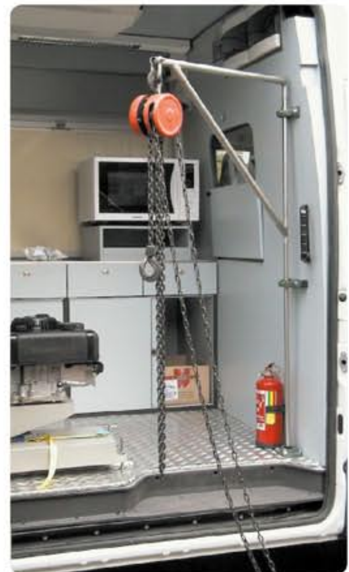
Laboratorio montado en furgoneta. Detalle de la grúa pequeña para la máquina de extracción de muestras
