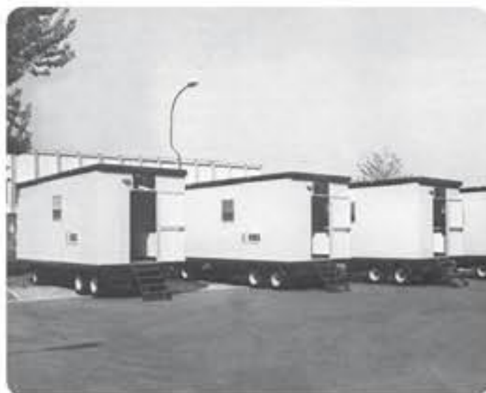
Flota de cinco laboratorios móviles montados en remolques suministrada a Dong Ah Construction Co. Para el gran proyecto de construcción de un río artificial en Libia.
