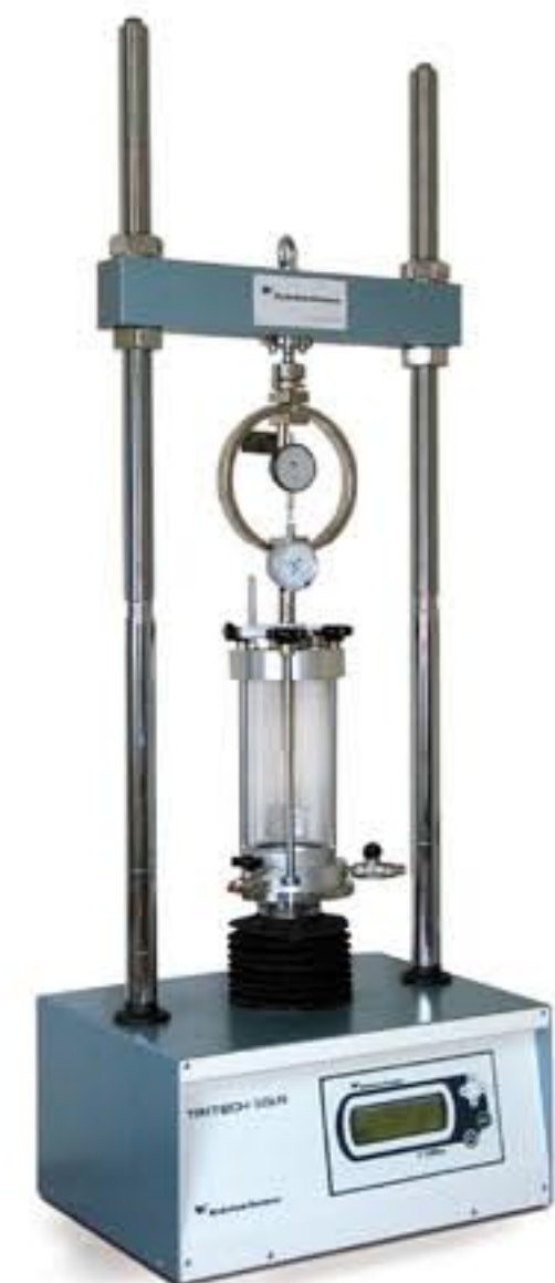
TRITECH 28-WF4005 con célula triaxial acanalada 28-WF4050, anillo dinamométrico y reloj comparador
