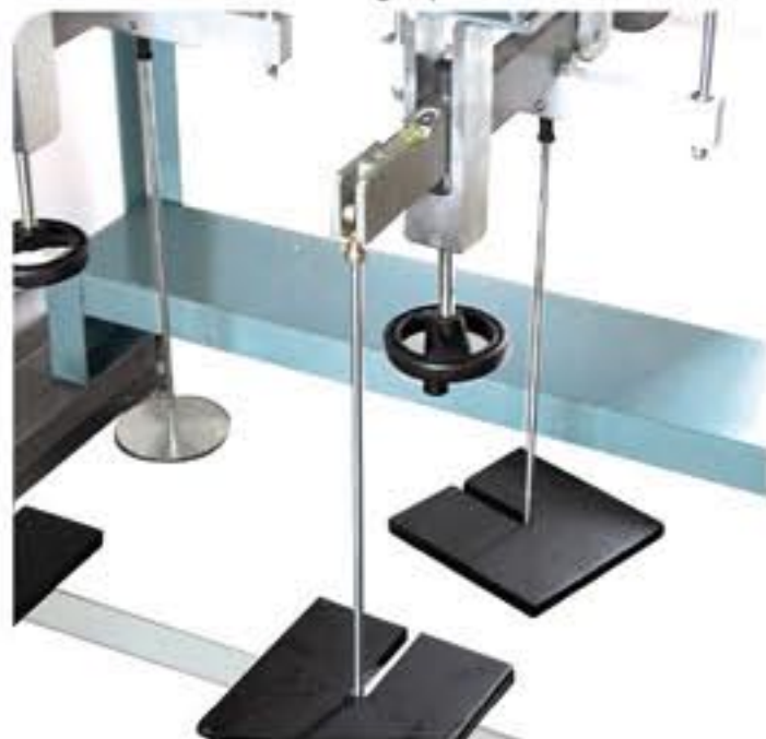
Detalle de la palanca de amplificación de la carga del 28-WF0493, de proporción 10:1
