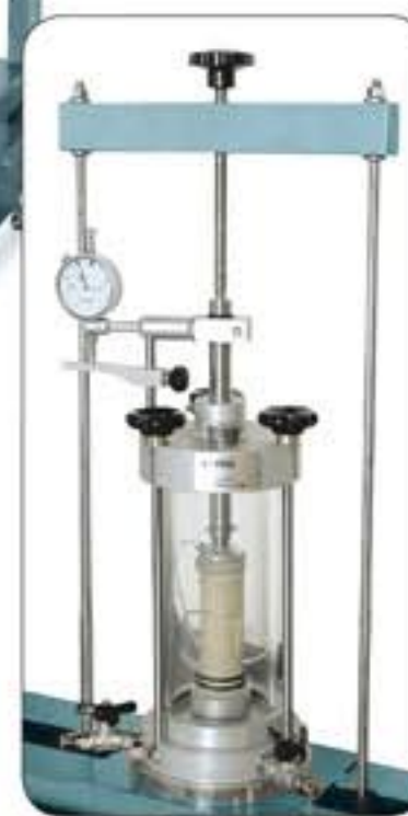
28-WF0493 Detalle del bastidor superior con la rueda para ajustar y nivelar la posición de la palanca de amplificación de la carga en cada una de las células triaxiales. La placa base también es compatible con células triaxiales de otros fabricantes siempre que estén equipadas con un orificio de centrado de 13 mm de diámetro por 3 mm de fondo.
