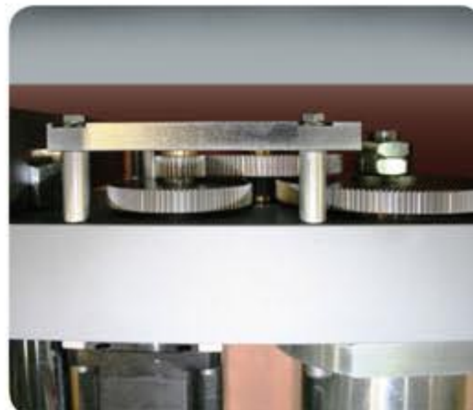
Detalle de la caja de engranajes. El sistema está diseñado para minimizar las vibraciones y permitir una transmisión suave
