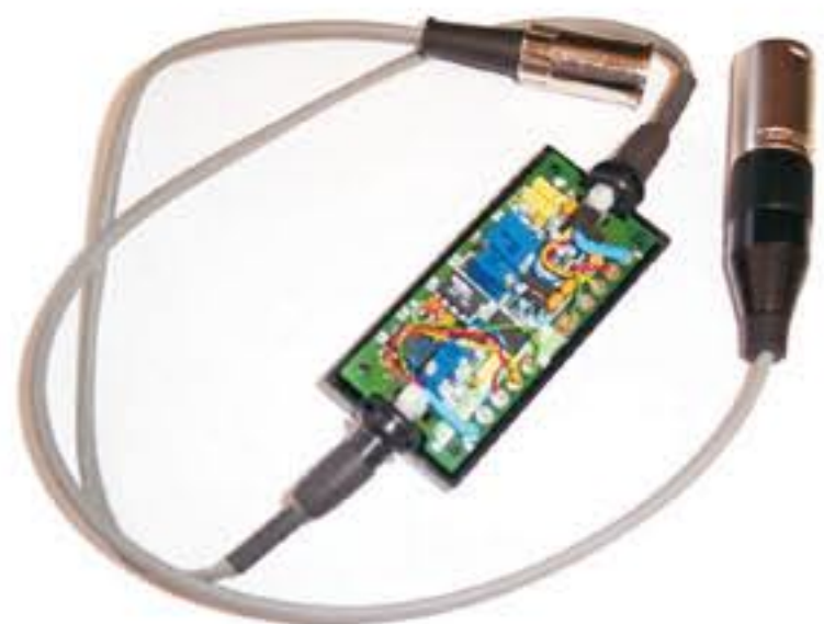
Módulo de calibración en línea para transductores usados en sistemas de ensayos dinámicos
