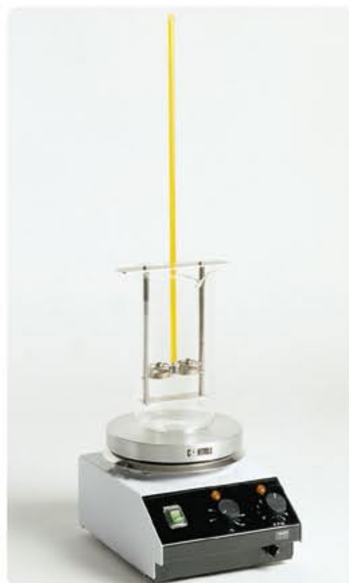
81-B0145/A con 81-B0145/D. Placa calentadora con sistema de agitador: práctica y fácil de utilizar
