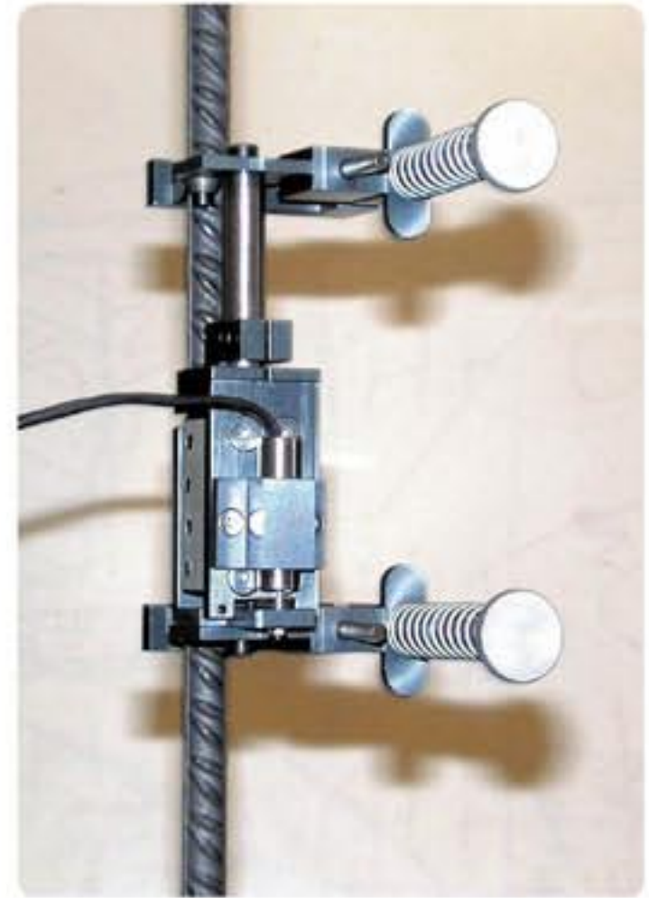
70-C0954/C Aplicación en barras de refuerzo de acero
