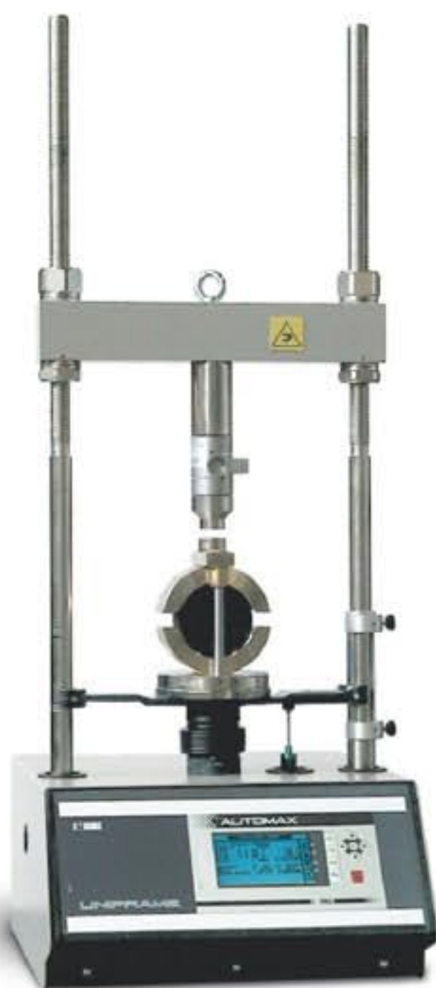
UNIFRAME 70-T0108/E equipado para ensayo Marshall (alternativo al 2)
