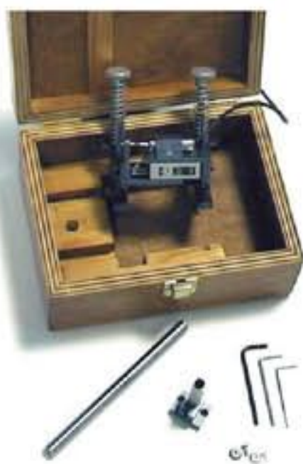
70-C0954/C Extensómetro universal
