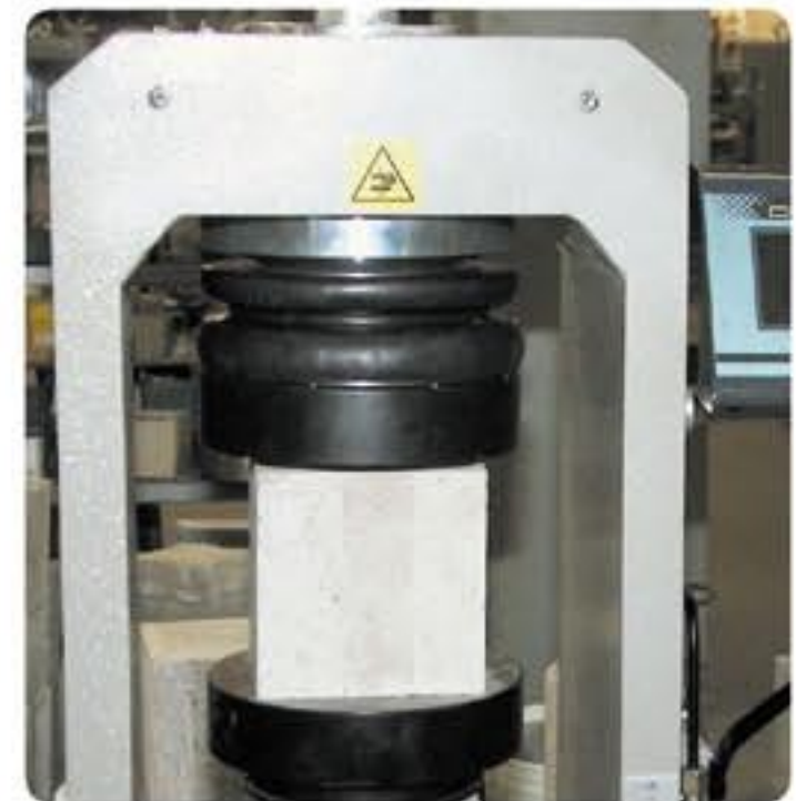
70-C0019/B con accesorio 70-C0019/41 para ensayos de compresión en cubos de hormigón de hasta 150 mm y cilindros de hasta 160 x 320 mm
