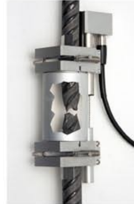
Vista transversal del extensómetro 70-C0961/B1 en funcionamiento
