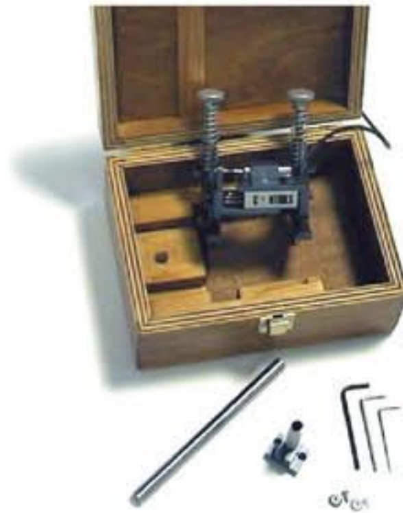
70-C0954/C Extensómetro universal
