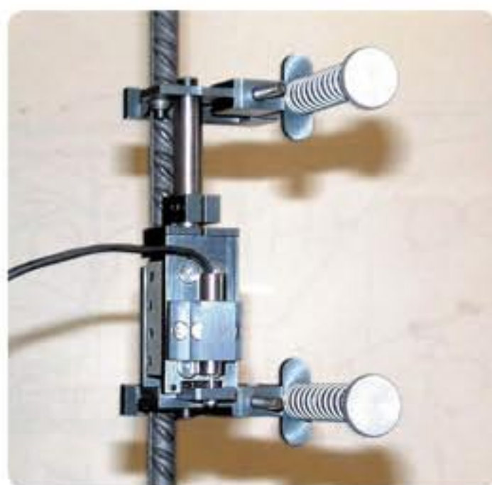
70-C0954/C Aplicación en barras de refuerzo de acero
