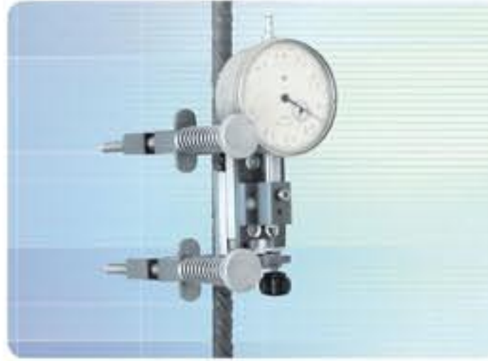
70-C0953/C fijado en la barra de refuerzo de ensayo
