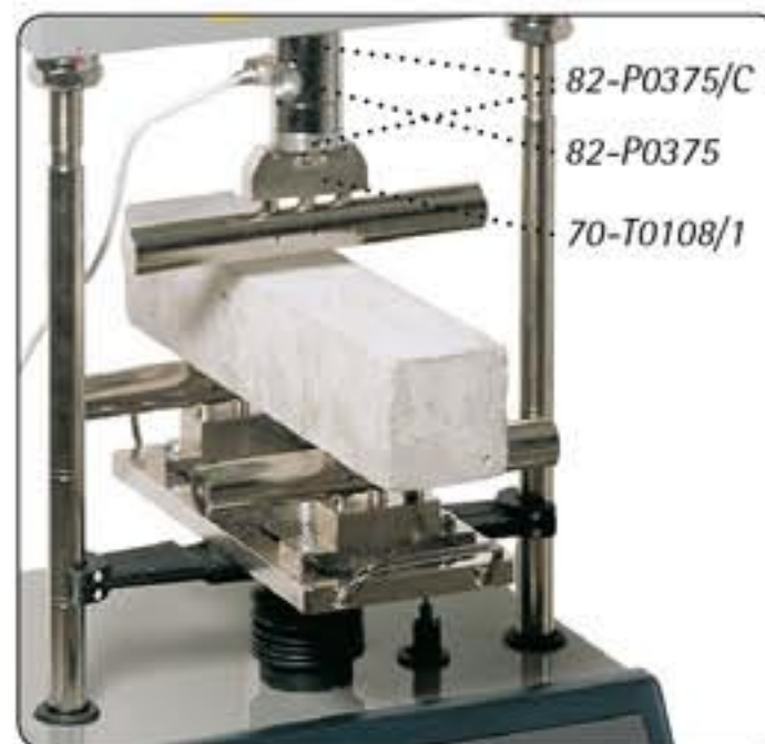
10 70-T0108/E equipado para ensayos de flexión en probetas prismáticas de hormigón (sólo con carga en el punto central)
