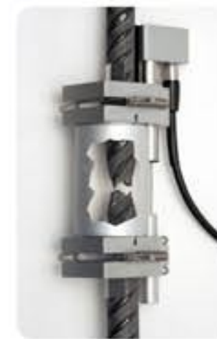
Vista transversal del extensómetro 70-C0961/B1 en funcionamiento
