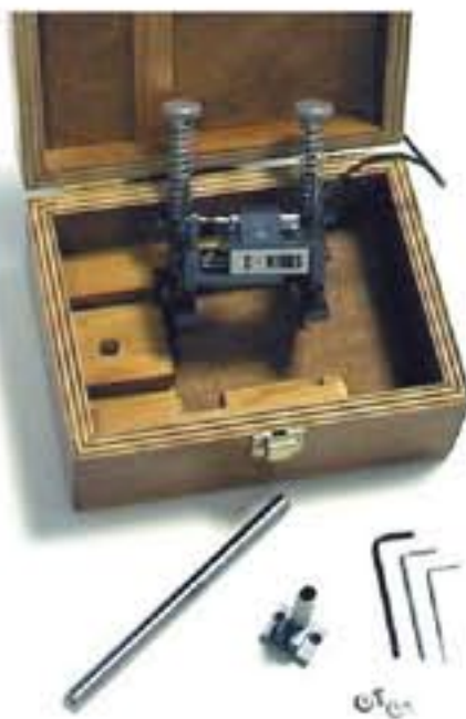
70-C0954/C Extensómetro universal
