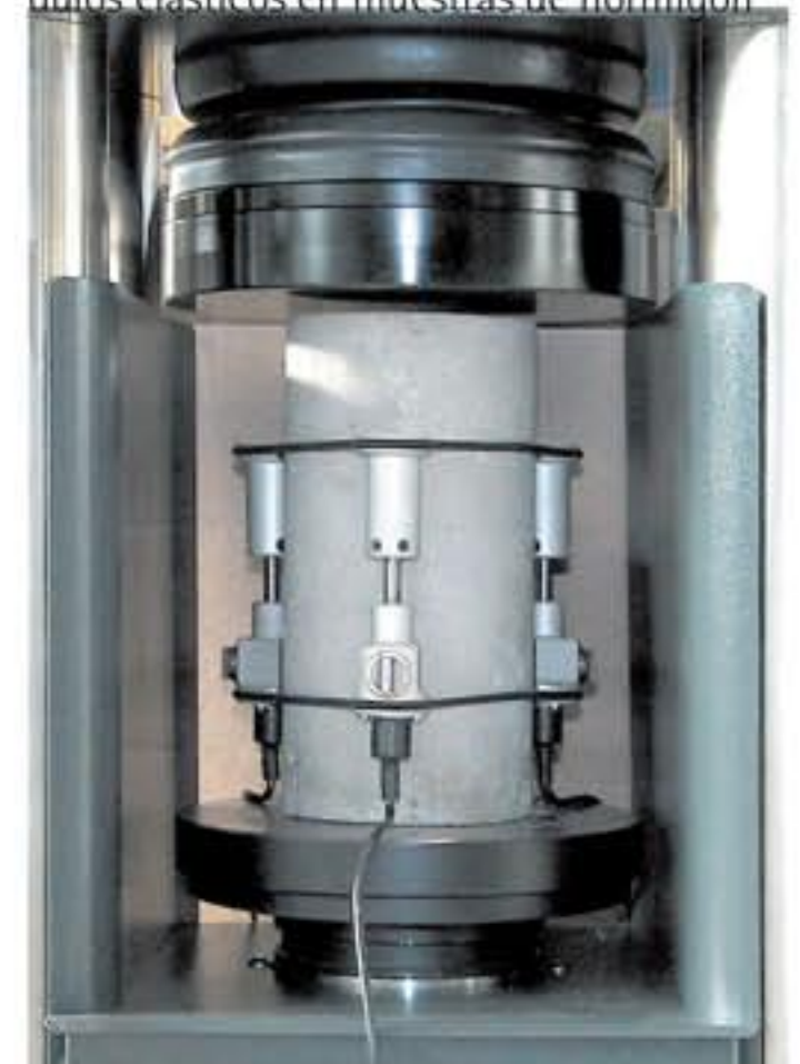
Tres compresímetros electrónicos 55-C0222/F equipados con una probeta cilíndrica durante la etapa de la compresión
