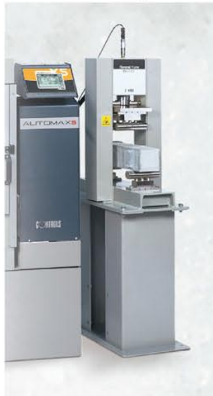
50-C0900/FR conectado a una máquina de ensayos automática Automax 5
