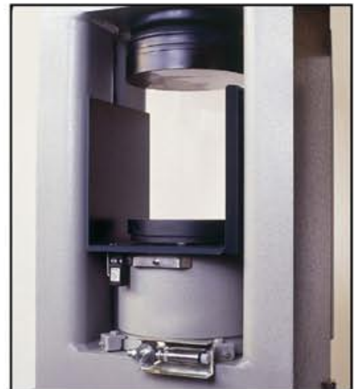
Detalle del conmutador de límite del recorrido del pistón
