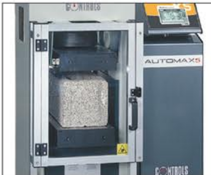
50-C4652 complementado con placas para ensayos de bloques 50-C4600/UP4
