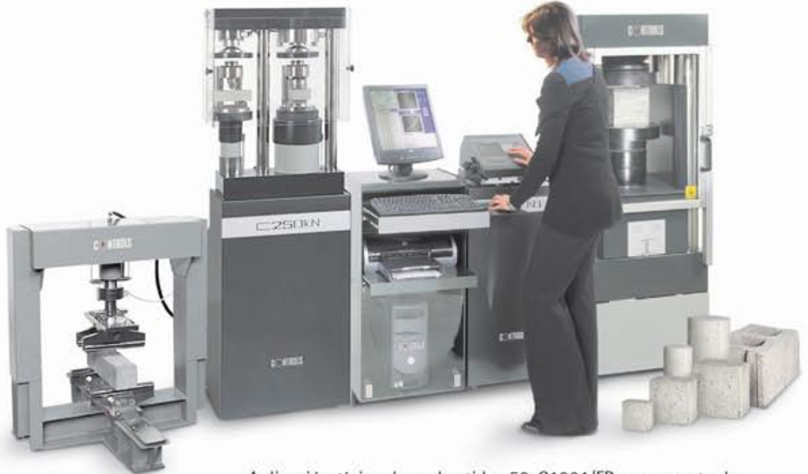
Aplicación típica de un bastidor 50-C1201/FR como parte de un sistema de ensayos completo controlado por la consola ADVANTEST 9 (ver página 247)
