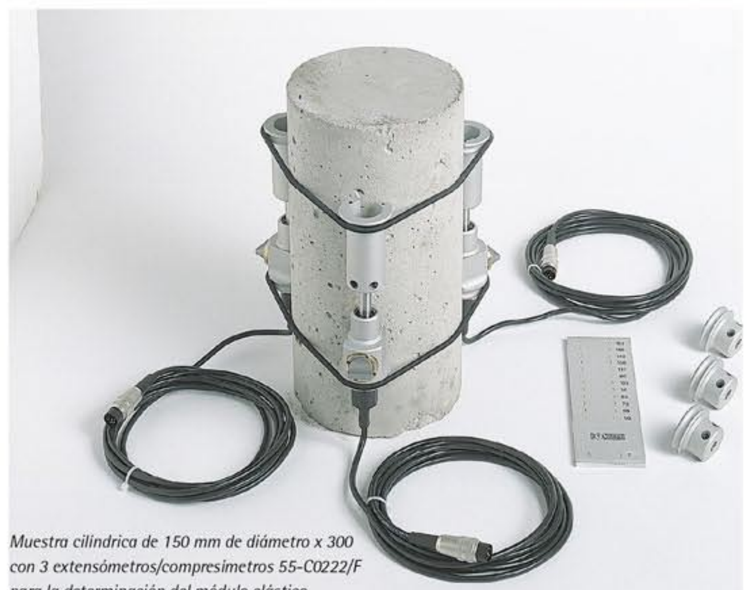
Ensayo cíclico de la determinación del módulo elástico con indicación gráfica de las desviaciones de la media de las lecturas de deformación
