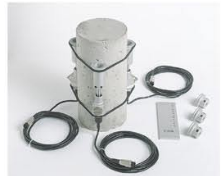
Diámetro Cilindro de 150 x 300 mm equipado con tres 55-C0222/F listo para un ensayo de módulo elástico. El detalle anterior muestra el dispositivo de bloqueo/desbloqueo del transductor
