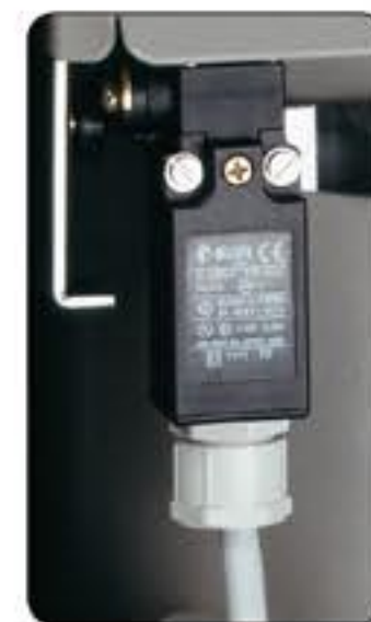
Detalle de conmutador del límite de recorrido del pistón 50-C2100/T y 50-C3100/T
