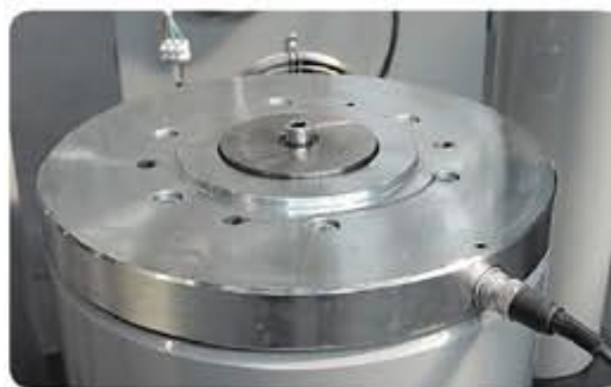
Célula de carga electrónica instalada en el pistón (modelo 50-C5902/FR)
