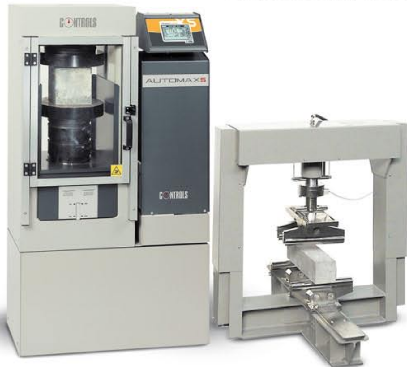
50-C5652 con distanciadores y opción de un segundo bastidor 50-Q0005/UP1 conectado a un bastidor de flexión 53-C1200/FR
