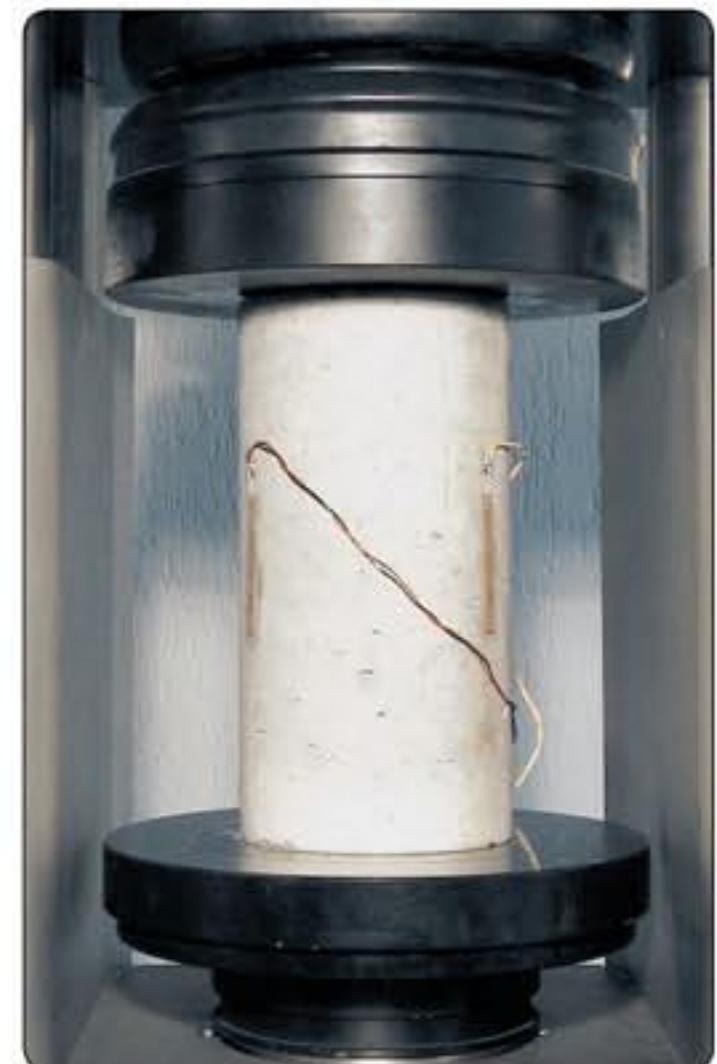
Determinación del módulo estático de elasticidad en compresión mediante una probeta cilíndrica con aplicación de galgas extensométricas
