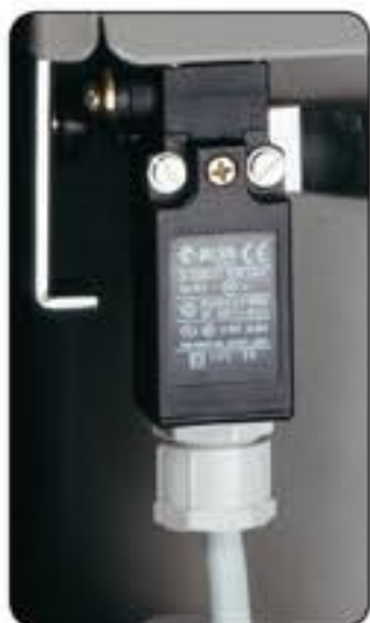
Detalle del conmutador de límite del recorrido del pistón
