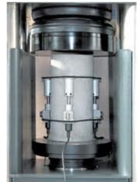
Determinación del módulo elástico de la muestra cilíndrica
