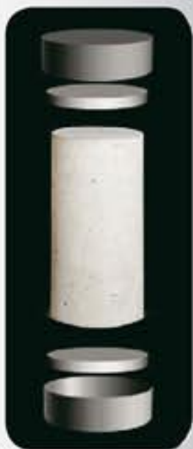
Configuración del ensayo utilizando retenedores de refrentado
