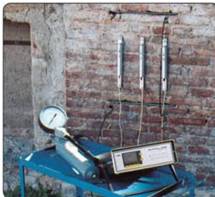
Aplicación típica de transductores electrónicos tubulares 58-D0585 con conjunto de bomba 58-D0568/A equipado con transductor de presión 82-P0351 y Datalog 82-P0908/A para adquisición completa de datos.
